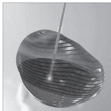
Рис. 2. Иллюстрация технологии карандашного сканирования.
