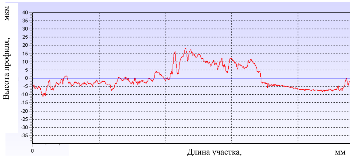
Рис. 14. Профилограмма поверхности контактной пары со сформированным оксидным покрытием после экспериментального исследования в расплаве свинца при T = 500^\circ\text{C} , термодинамической активности кислорода 10^0 , удельной нагрузке 12 \text{ кг/см}^2 , шероховатости поверхности Ra = 1,8 (x400)
